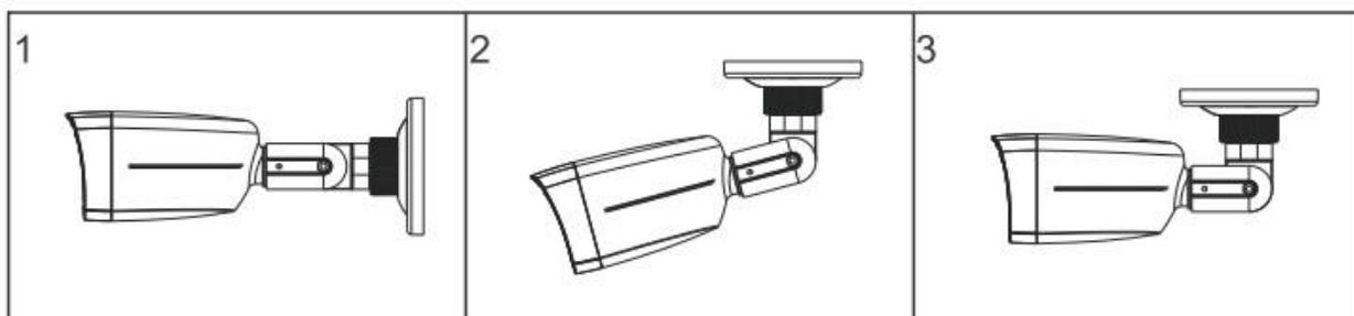
1. Установите камеру на нужное место и закрепите её при помощи трёх винтов или саморезов.
